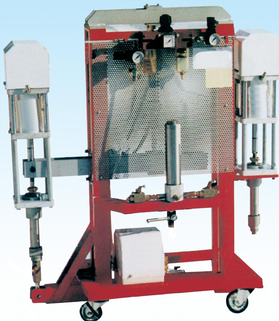
Impianto pneumatico airless bicomponente a rapporto variabile montato su carrello con Riduttori e Filtri di linea
